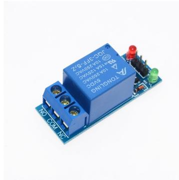
Figura 3.11: Ilustración de Modulo Relay
