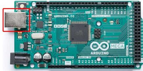
Figura 3.8: Imagen ilustrativa de entrada USB de la placa Arduino Mega 2560 [8].
