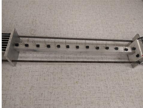
Figura 3.14: Ilustración de sensores LM35 colocados en varilla de aluminio.
